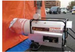
暖房能力33kwの強力暖房機。燃焼ガスは煙突から排気、クリーンな外気を暖めてテント内に送ります。
